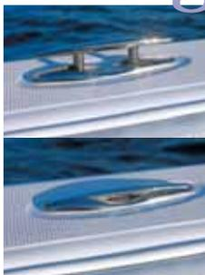
Guarda-mancebo, três cunhos, olhais para reboque, bocais para abastecimento de combustível e água e até mesmo a capota central tipo T-top são itens de série. O aço inox é o padrão 316, mais resistente à corrosão que o aço inox 304, usado na maioria das lanchas.
